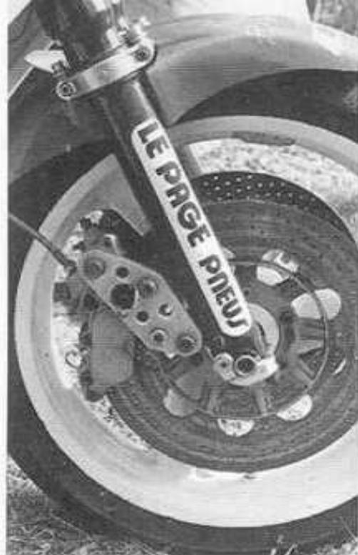
Montage d'étriers Brembo sur des fourreaux de fourche de VF 1000 R (photo RMT)
