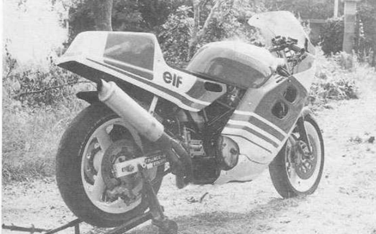
Le carénage est calqué sur celui d'origine avec obturation des orifices (phare et clignotant). Les deux tubes d'échappement rejoignent un pot arrière de fabrication maison (photo RMT)
